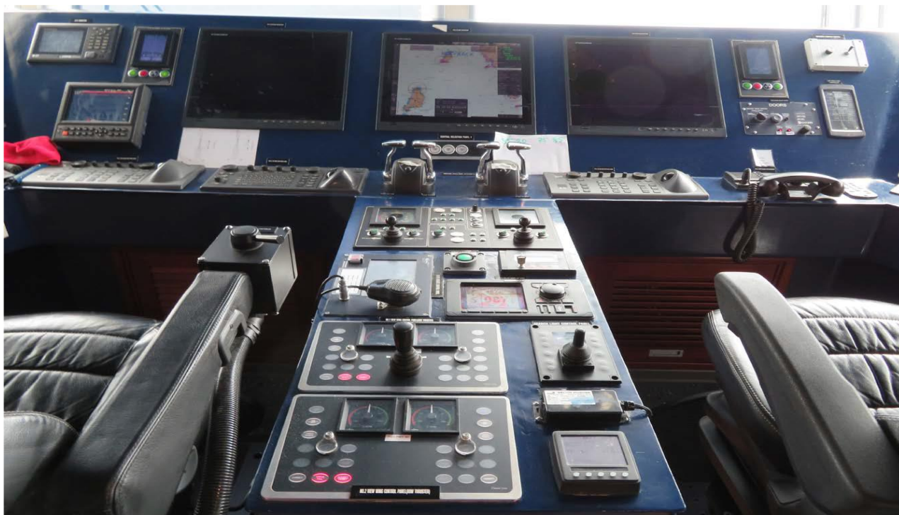
Figure 4 : Console centrale de l'officier de quart (OQ), montrant la disposition des commandes de barre et de l'équipement de navigation
