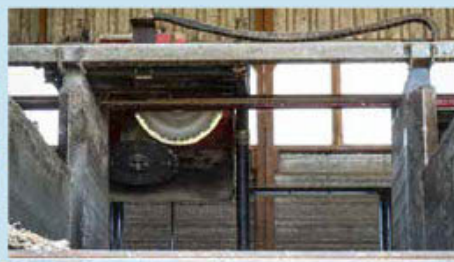
La cuisine T40 est composée de quatre tables de stockage en inox de neuf mètres de longueur. Ces dernières sont équipées de convoyeurs à chaînes qui avancent ou reculent les cubes de fourrage. Un lamier bilame permet de débiter «des tranches» de fourrage dans le cube pour le désiler.
