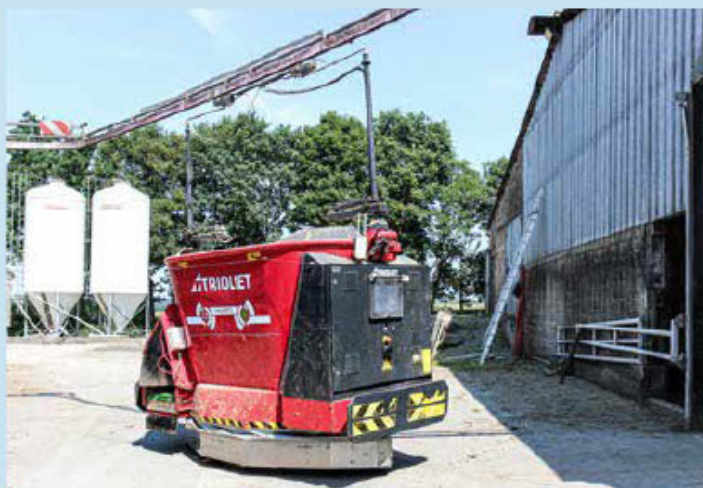
Le wagonnet WP se déplace en roulant dans l'exploitation. Il est alimenté par un rail électrifié placé jusqu'à 4,20 m de hauteur qui a aussi pour rôle de le guider dans ses déplacements (un système de pont permet de relever le rail de 1,5 m).
