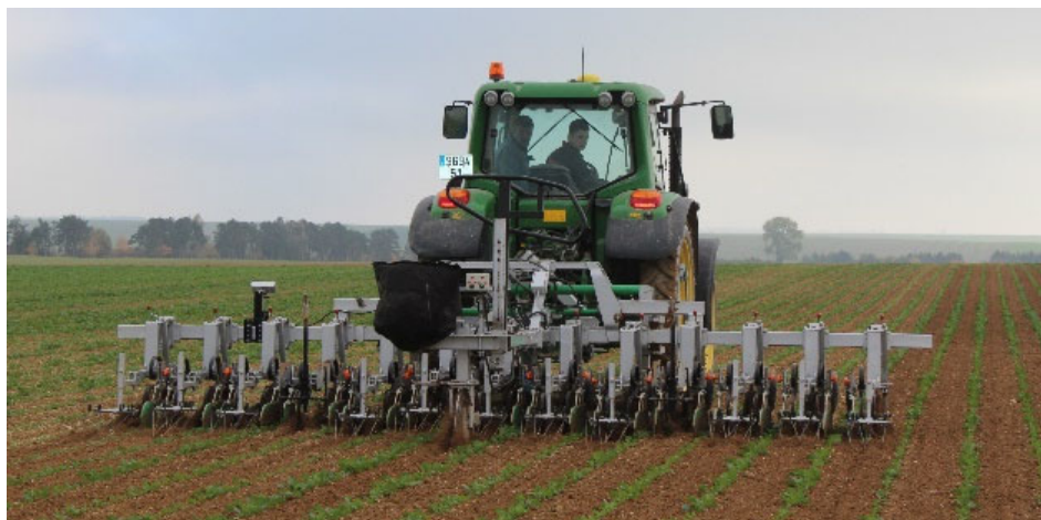
Figure 2: Bineuse inter-rang avec option moulinet Agronomic
