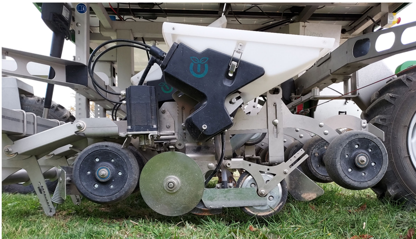
Figure 1: Vue d'ensemble d'un élément semeur
