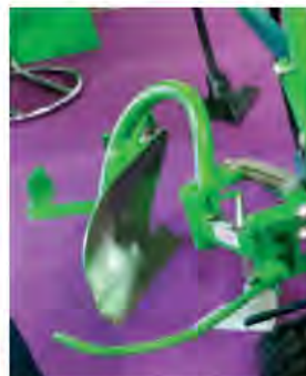
L'effacement devant les pieds se fait selon un mouvement parallèle à l'axe du rang.
